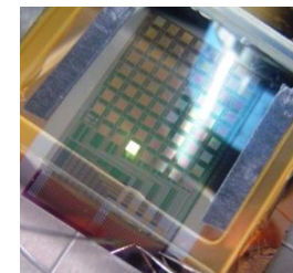
フレキシブル電子回路 材料と基板の密着性
